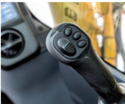
Joysticks mit Proportionalsteuerung für Anbaugeräte
