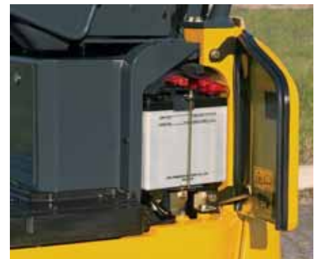
Linke Wartungsklappe: leichter Zugang zur Batterie
