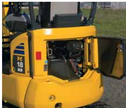
Hintere Wartungsklappe: schnelle Motorinspektion und Betankung
