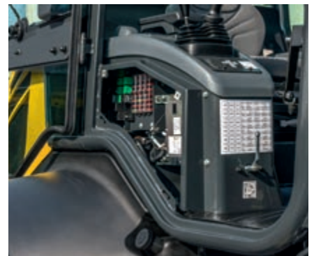
Seitliche Wartungsklappe für schnellen Wartungszugang
