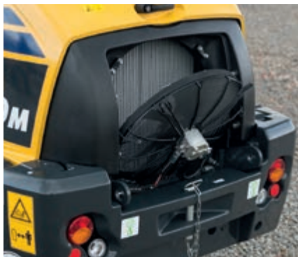
Kippbarer Kühlerlüfter für bequeme Reinigung
