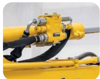
Sicherheitsventile an Ausleger- und Stielzylindern
