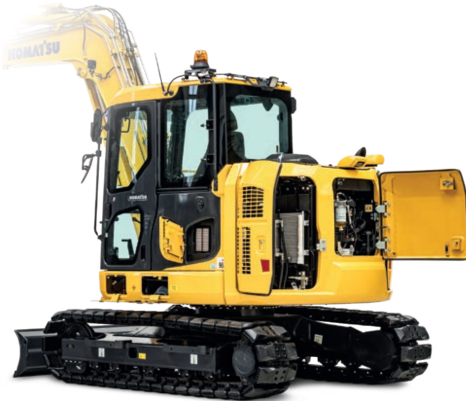
Alle wichtigen Wartungspunkte sind bequem vom Boden aus erreichbar
