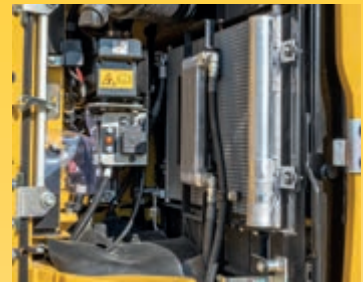
Side-by-Side Kühler für einfachsten Zugang zur Reinigung
