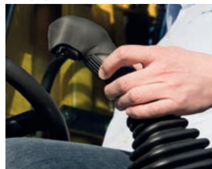
Das optional verfügbare und anpassbare Joystick-Lenkssystem ermöglicht leichtgängiges Lenken der Maschine ohne großen Kraftaufwand
