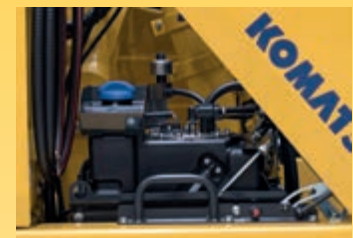
Einfacher Zugang zum AdBlue®-Tank
