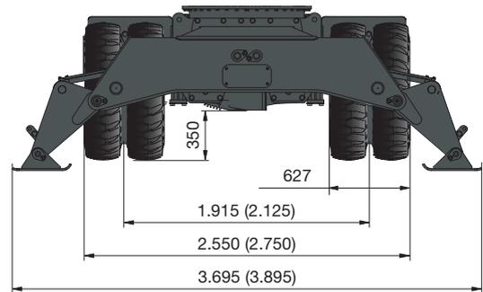
Alle Abmessungen mit Bandenmarkt Excavator 315/70 R22.5 Bereifung
