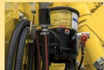
Automatische Zentralschmieranlage (Option)
