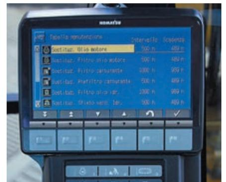
Der LCD-Monitor zeigt Unregelmäßigkeiten und Wartungsintervalle an
