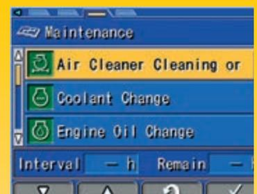
Das weiterentwickelte Multifunktionsmonitorsystem versorgt den Fahrer mit Wartungsinformationen.
