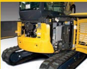
Hintere Wartungsklappen für schnelle Motorinspektion und Betankung, einfachen Wartungszugang, leichte Reinigung der Kühler und guten Zugang zur Batterie
