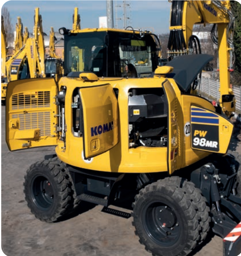
Alle wichtigen Wartungspunkte sind bequem vom Boden aus erreichbar
