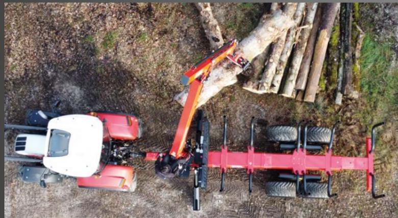
Doppelte Runge über der Achse
