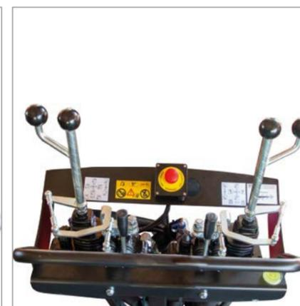
Drehkreuzhebel 2-Kreis Steuerung
