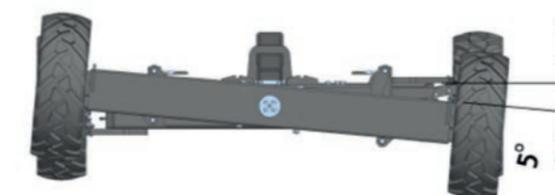
Die Pendelachse sorgt dafür, dass stets alle vier Räder Bodenkontakt haben. Im Kranbetrieb wird die Pendelachse hydraulisch automatisch gesperrt.
